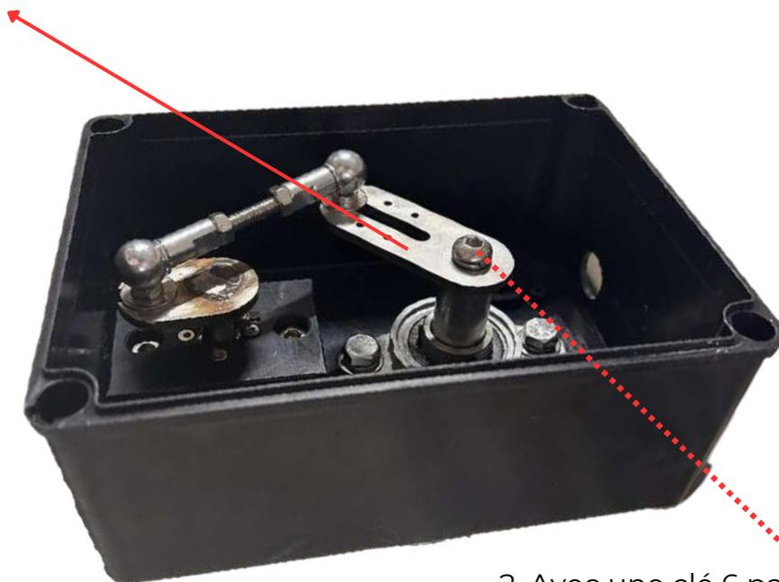
2. Avec une clé 6 pans de 6mm, tenez l'arbre et desserrez la vis D019
