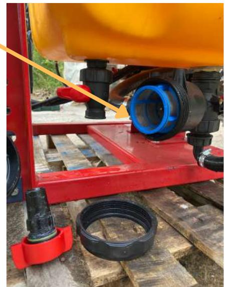
2. Remonter le filtre bleu et appliquer de la graisse marine sur la portée de joint
