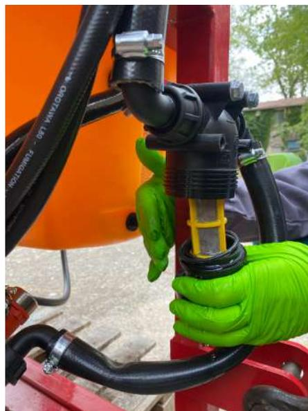
4. Egalement pour le Filtre de tronçon vert (A l'arrière du pulvé)
