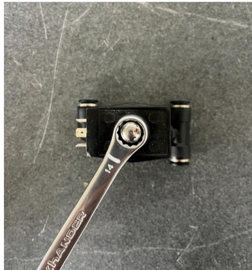
2. Prendre une clé de 14 → Desserrer l'écrou supérieur de l'électrovanne
